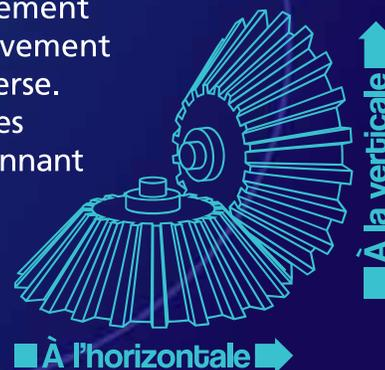
L'engrenage de la **perceuse** produit un mouvement de rotation qui permet de faire des trous dans divers objets tels que le bois, le ciment ou les métaux. La roue d'entrée est tournée verticalement et transmet un mouvement horizontal grâce à un système d'engrenage conique. Le mouvement est ainsi transféré d'un plan à un autre.
